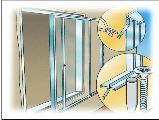
*Figura 1 – Instalação de janela chumbada*
