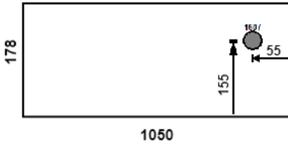
**INSTALAÇÃO: ESPELHOS PRATA DE 04MM COM ACABAMENTO DE BISOTÊ, DEVIDAMENTE INSTALADO COM FIXA ESPELHO ,**
