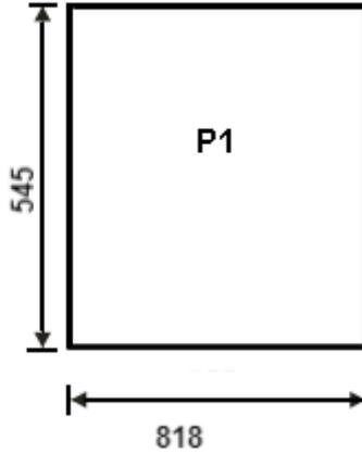
**INSTALAÇÃO: TAMPO EM VIDRO TEMPERADO DE 08MM INCOLOR, DEVIDAMENTE INSTALADO COM APOIO DE SILICONE. ,**
