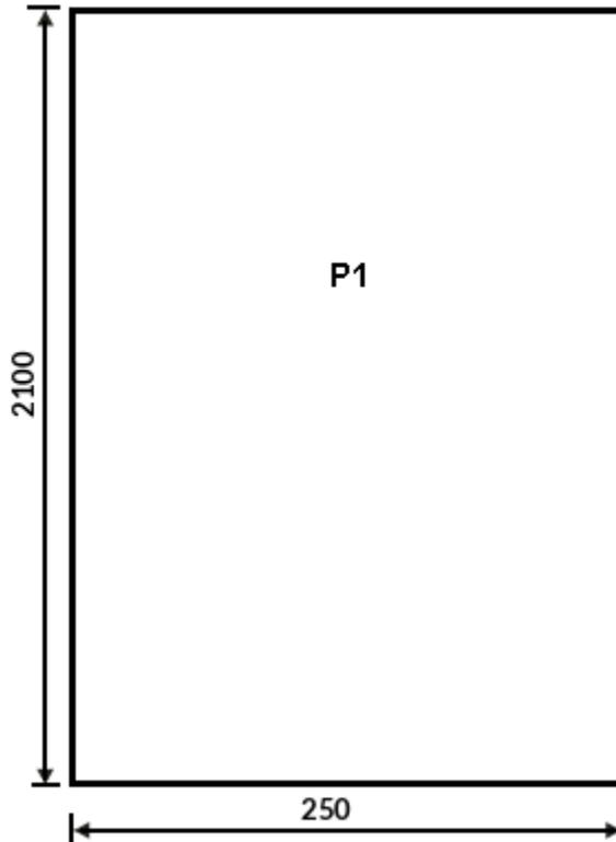
**INSTALAÇÃO: VIDRO COMUM DE 06MM INCOLOR COM ACABAMENTO DE LAPIDAÇÃO, DEVIDAMENTE INSTALADO COM APOIO DE SILICONE. ,**
