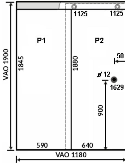
**INSTALAÇÃO: BOX FRONTAL EM VIDRO TEMPERADO DE 08MM INCOLOR, SENDO 01 LAMINA FIXA E 01 LAMINA DESLIZANTE, DEVIDAMENTE INSTALADO COM KIT EM ALUMINIO PRETO.,**
